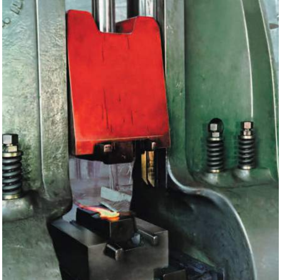
Tooth forceps hot forging process. Fase di stampaggio a caldo di una tenaglia per estrazioni.
